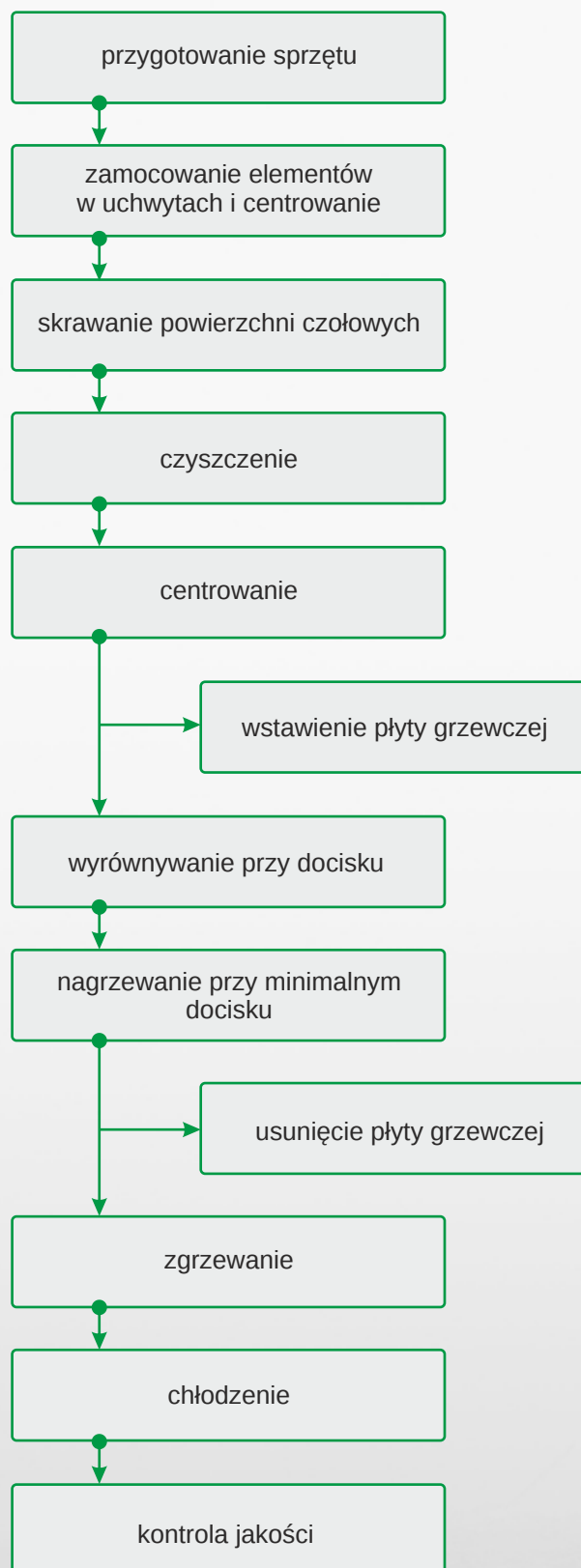
Rysunek 1. Schemat blokowy procesu zgrzewania czołowego.
